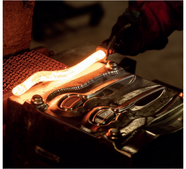
Pieza forjada al rojo vivo Red-hot forged piece Pièce forgée incandescente
